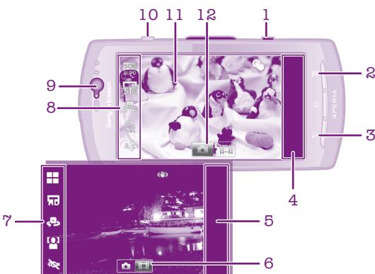
1 Клавиша камеры. Включение камеры/фотосъемка/видеосъемка
