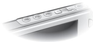
Для управления проигрывателем Walkman™, видеопроигрывателем и радиоприемником можно использовать клавиши музыкального проигрывателя. Эти клавиши работают также при включенной блокировке клавиатуры,
