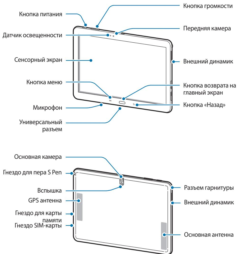
Микрофон в верхней части устройства активен только при использовании громкой связи или съемке видео.
