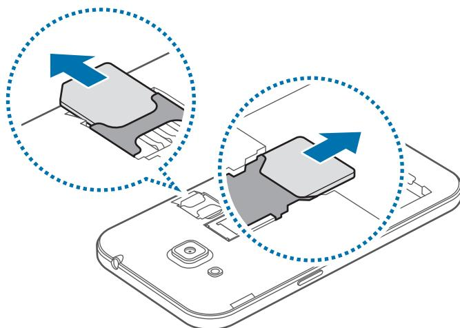
► Модели с одной SIM-картой: нажмите пальцем на SIM- или USIM-карту и вытащите ее.
