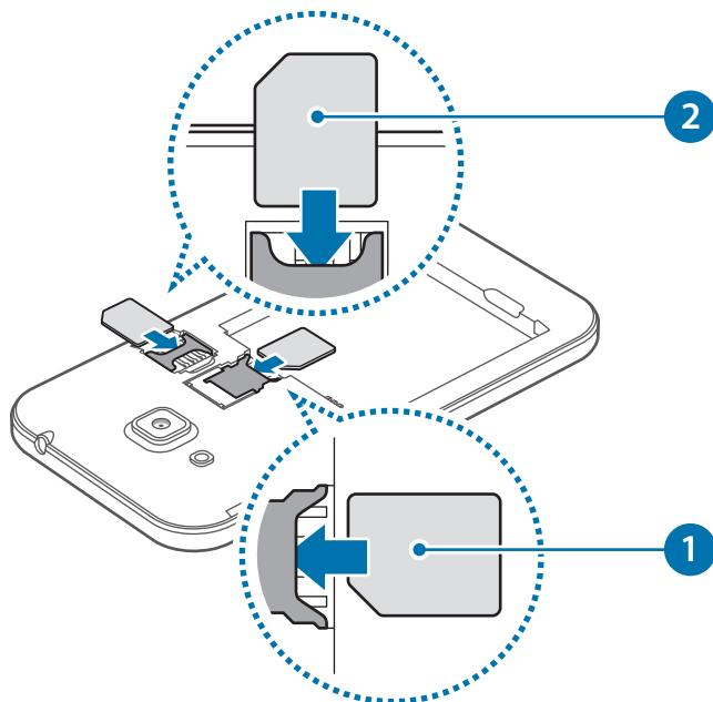
► **Модели с одной SIM-картой:** вставьте SIM- или USIM-карту в устройство золотистыми контактами вниз.
