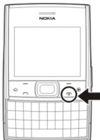
Нажмите и удерживайте нажатой клавишу включения для включения и выключения устройства. Кратковременным нажатием этой клавиши можно завершить активный вызов или закрыть приложение.
