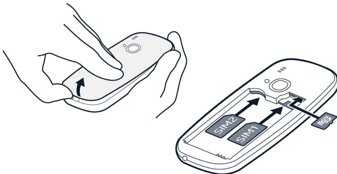
1. Вставьте ноготь в небольшой разъем в нижней части телефона, поднимите и снимите крышку.
