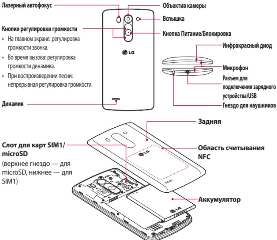
**Датчик LDAF (датчик автофокуса с лазерным дальномером):** путем определения расстояния с помощью лазера при записи видео задней камерой датчик LDAF позволяет быстрее и точнее фокусироваться на удаленных и близких объектах.
