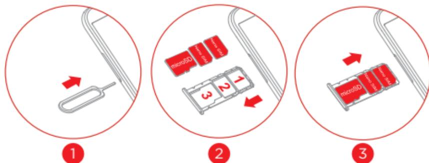
**Шаг 1.** Вставьте инструмент для извлечения сим-карты (входит в комплектацию смартфона) в небольшое отверстие в слоте для SIM карт.
