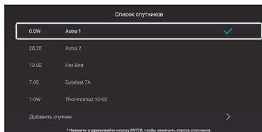
**Настройка спутника:** Используйте ▲/▼ для выбора подменю, далее нажмите **OK** для входа в настройки. Если выбран тип коммутатора универсальный, то в этом меню вы можете установить частоту спутниковой LNB антенны, транспондер, опцию 22кГц, Tone Burst (мини DiSEqC), питание LNB антенны; отобразить мощность (уровень) и качество сигнала. В случае выбора SatCR можете установить частоту LNB антенны, транспондер; отобразить мощность и качество сигнала.
