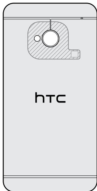
Убедитесь, что область NFC (заштрихованная часть) HTC One и область NFC второго телефона расположены близко друг к другу. Попробуйте слегка перемещать телефоны до тех пор, пока не будет установлено соединение.
