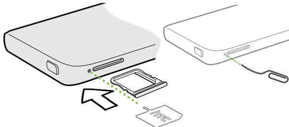
3. Нажмите кончиком инструмента внутрь отверстия до упора, чтобы выдвинуть лоток SIM-карты.
