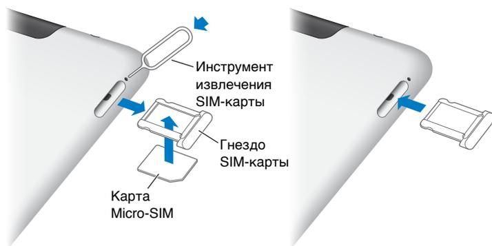
**Открытие гнезда SIM-карты** Вставьте конец инструмента для извлечения SIM-карты в отверстие гнезда SIM-карты. Нажмите и протолкните инструмент внутрь до появления лотка. Вытяните гнездо SIM-карты для установки или замены карты SIM-карты. При отсутствии приспособления для извлечения SIM-карты можно использовать конец канцелярской скрепки.
