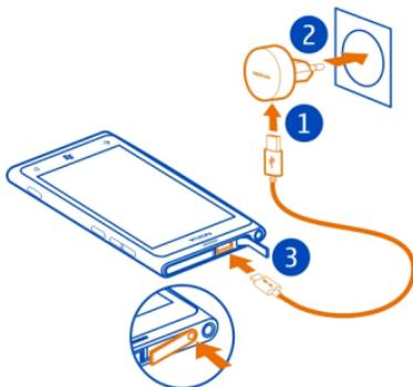
2 После полной зарядки аккумулятора отключите зарядное устройство от телефона, а затем от сетевой розетки.
