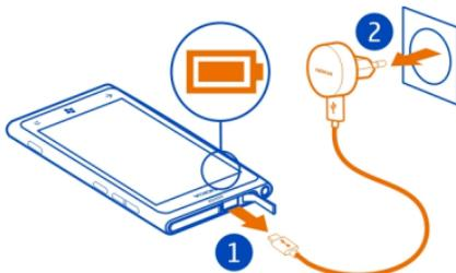
Во избежание повреждения разъема для подключения зарядного устройства аккуратно подключайте и отключайте кабель зарядного устройства.
