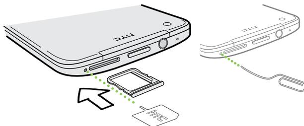
3. Нажмите кончиком инструмента внутрь отверстия до упора, чтобы выдвинуть лоток с SIM-картой.
